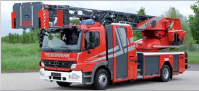
Metz L32A; Mercedes Benz Atego 1529F 4x2; fünfteiliger Leiterpark, abneigbarer Korbarm (Gelenk mit 3,8 m)
