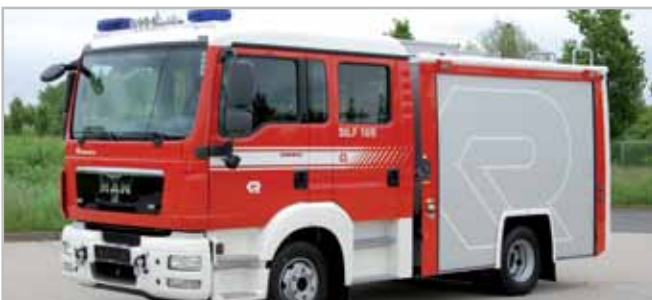
Rosenbauer StLF (Staffelöschfahrzeug) 10/6; MAN 8.180.4x2 BB; CL – Leichtaufbau
