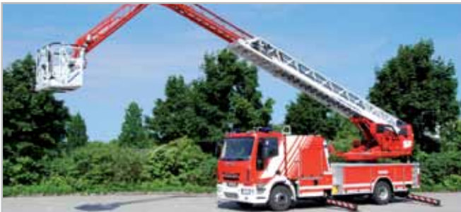
Iveco Magirus M32 L-AS; Iveco 160E30 4x2; vierteiliger Leiterpark, Knick im ersten Auszug auf 4,7m Länge
